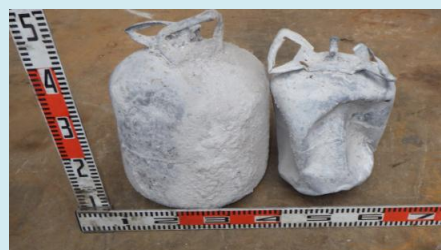
焼却炉から排出されたガスボンベ
